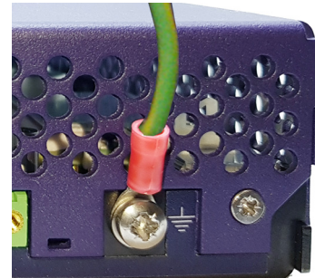
Borne de terre à l'arrière de OTU
