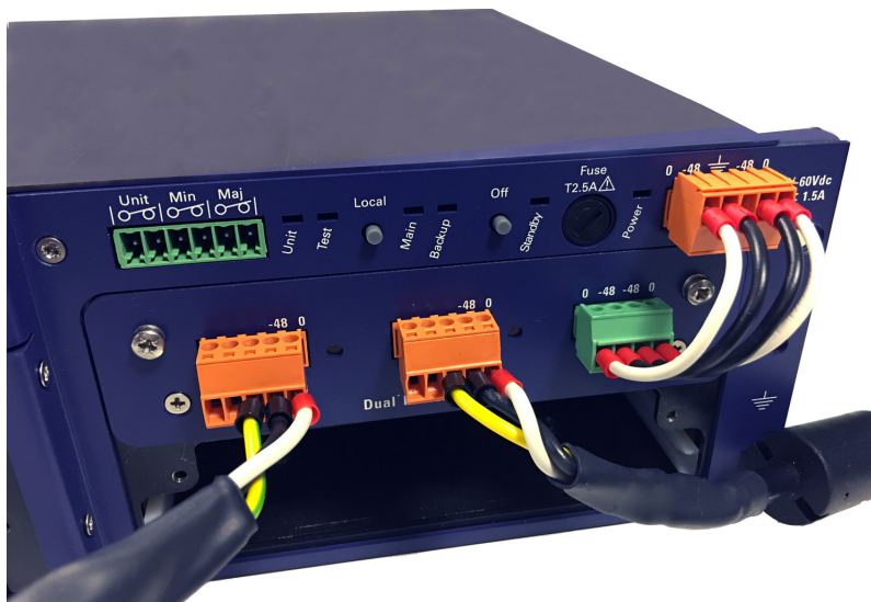
Figure 19 Branchement pour la double alimentation
